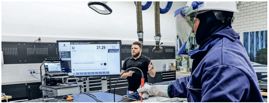
Arbeiten an Hochvoltbatterien erfordern viel Fachwissen, Schutzausrüstung und Respekt. Bisher wurden defekte HV-Batterien meist als komplette Module ersetzt. Die teuren Komponenten müssen aber reparierbar und entsprechend auch Ersatzteile, Prüfgeräte wie auch Spezialwerkzeuge vorhanden sein. Nach dem Ausmessen der Batterie und Prüfungen mit dem Testgerät in verschiedenen Teilschritten geht es an die Zerlegung und den Austausch fehlerhafter Module.
