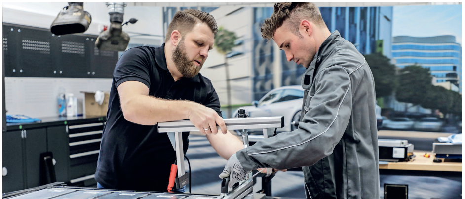
Die Batteriemodule sind oft mittels Wärmeleitpaste im Batteriegehäuse angebracht, um den Wärmeaustausch im Betrieb zu optimieren. Entsprechend muss mittels Rahmen ein defektes Modul quasi mechanisch herausgehoben werden.
