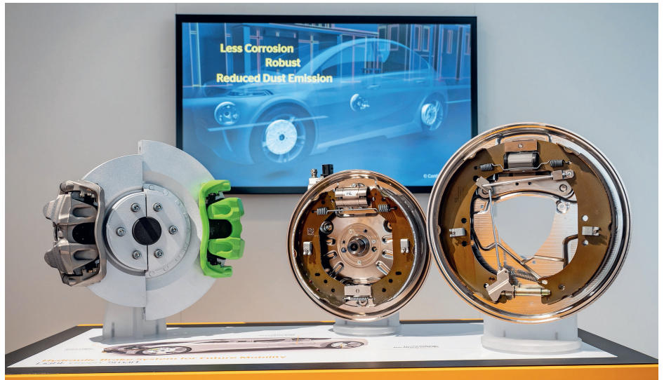
Aufgrund der Limitation der maximalen Bremsstaubemissionen erlebt die Trommelbremse eine Wiedergeburt. Durch die geschlossene Ausführung werden im Betrieb deutlich weniger Feinstaubpartikel emittiert. Foto: Continental
