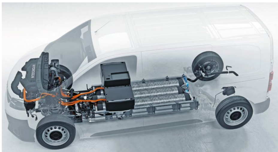
L'Opel Vivaro équipé de la technologie de la pile à combustible montre que l'industrie des véhicules utilitaires propose toutes les transmissions existantes et que seuls l'acceptation par le marché et les besoins de transport sont déterminants. Photo: Stellantis
