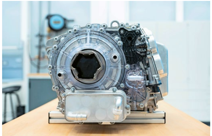
Les deux raccords de liquide de refroidissement assurent la dissipation de la chaleur au niveau du disque de freinage. Photo : Mercedes-Benz
