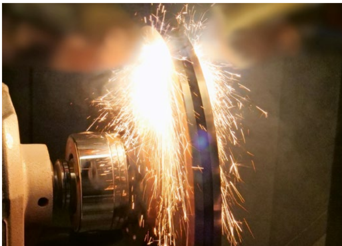
Des variantes de métal appliquées par laser permettent d'optimiser les éléments de friction. Photo : Laserline
