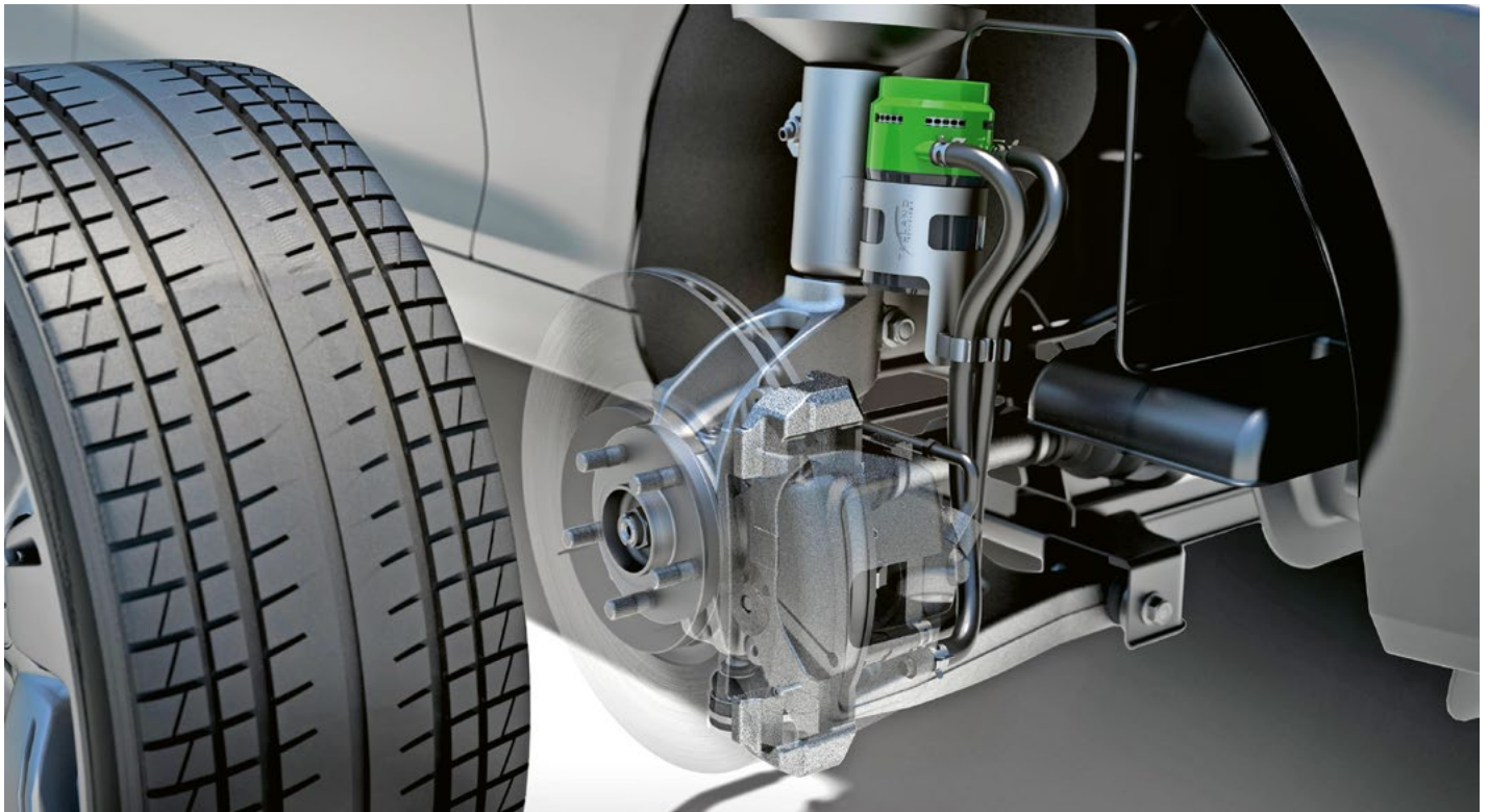
L'industrie des fournisseurs bricole des dispositifs d'aspiration ou des systèmes de filtrage passifs pour aspirer (activement) ou absorber (passivement) la poussière de frein des variantes de disques de frein pendant le processus de décélération. Photo: Tallano
